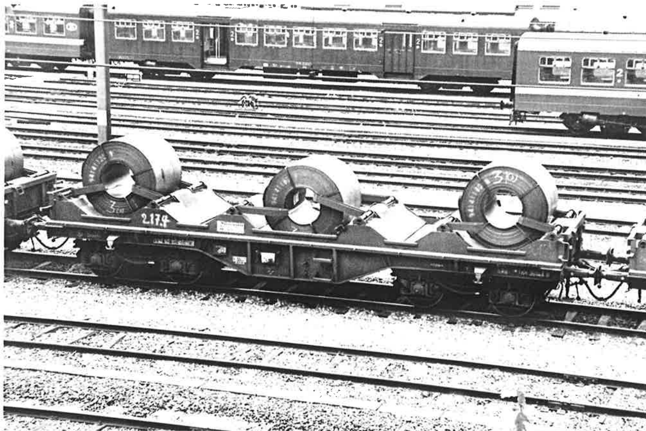
Wagon pour le transport de coils, Shmms, type 3614A8, en gare de Leuven, le 13 mai 1995. Remarquez les bras de calage latéraux – photo Camille Nain
